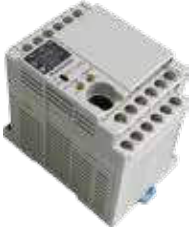
AFPX-C14TD CPU8 Giriş (PNP/NPN)6 NPN ÇIKIŞ 24VDC PLC
