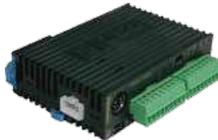
FP0R-E16RS 8*24VDC GİRİŞ (PNP/NPN), 8*PNP ÇIKIŞ EK MODÜL
